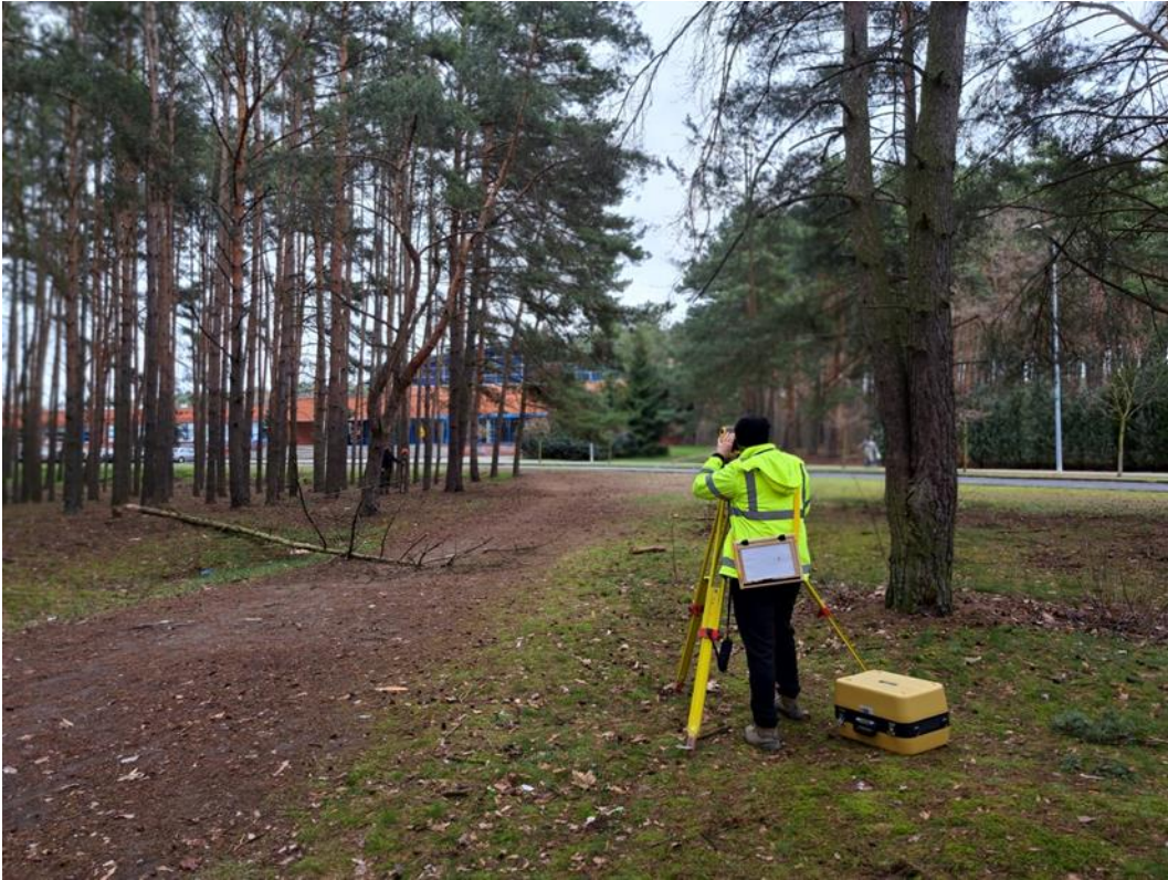
Fot. Wykonywanie pomiarów sytuacyjnych tachimetrem TOPCON OS-203.
